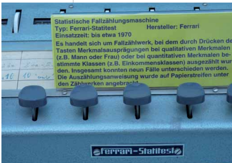
Die original Ferrari-Statitest, eine Fallzählmaschine aus dem Bestand des Statistischen Landesamtes. Ausgemustert 1970.
